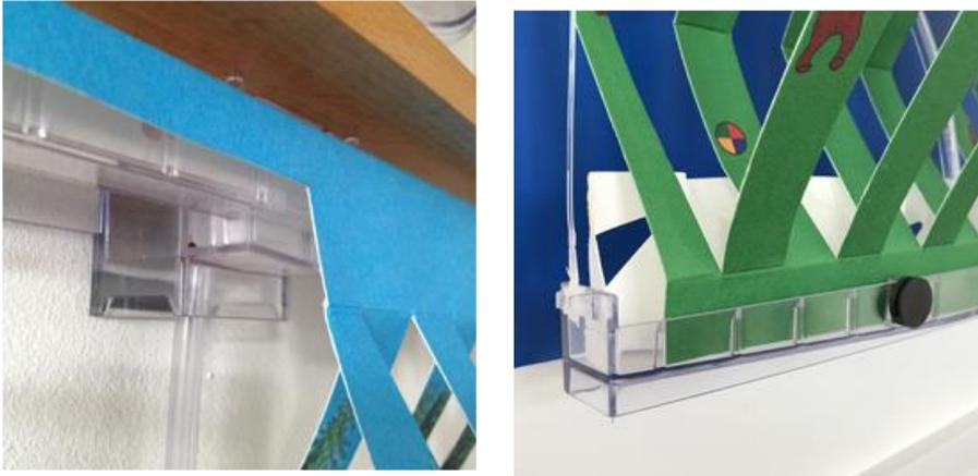
Der Wassertank bringt das Wasser in eine Vorkammer, von welcher es auf das 3D-Poster fließt. Wenn sich Wasser im Auffangbecken staut (ganz unten), wird die Vorkammer entleert. Im Auffangbecken wird das Wasser vom Kalkausscheider übernommen und verdunstet. Die Vorkammer wird sich nun wieder füllen und Wasser ins Vlies schwemmen.
